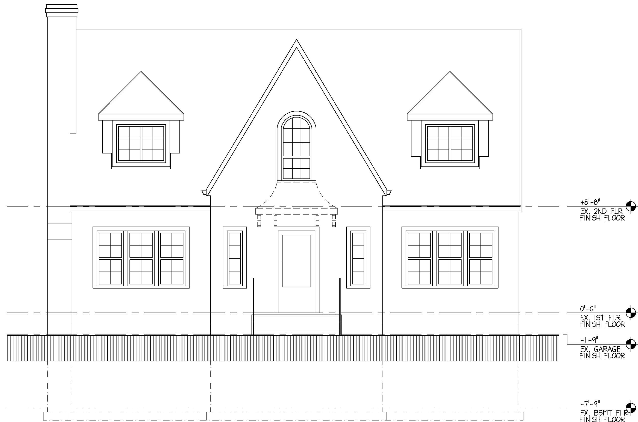
A EXISTING EXTERIOR 'FRONT' ELEVATION A103 SCALE: 1/4"=1'-0"
