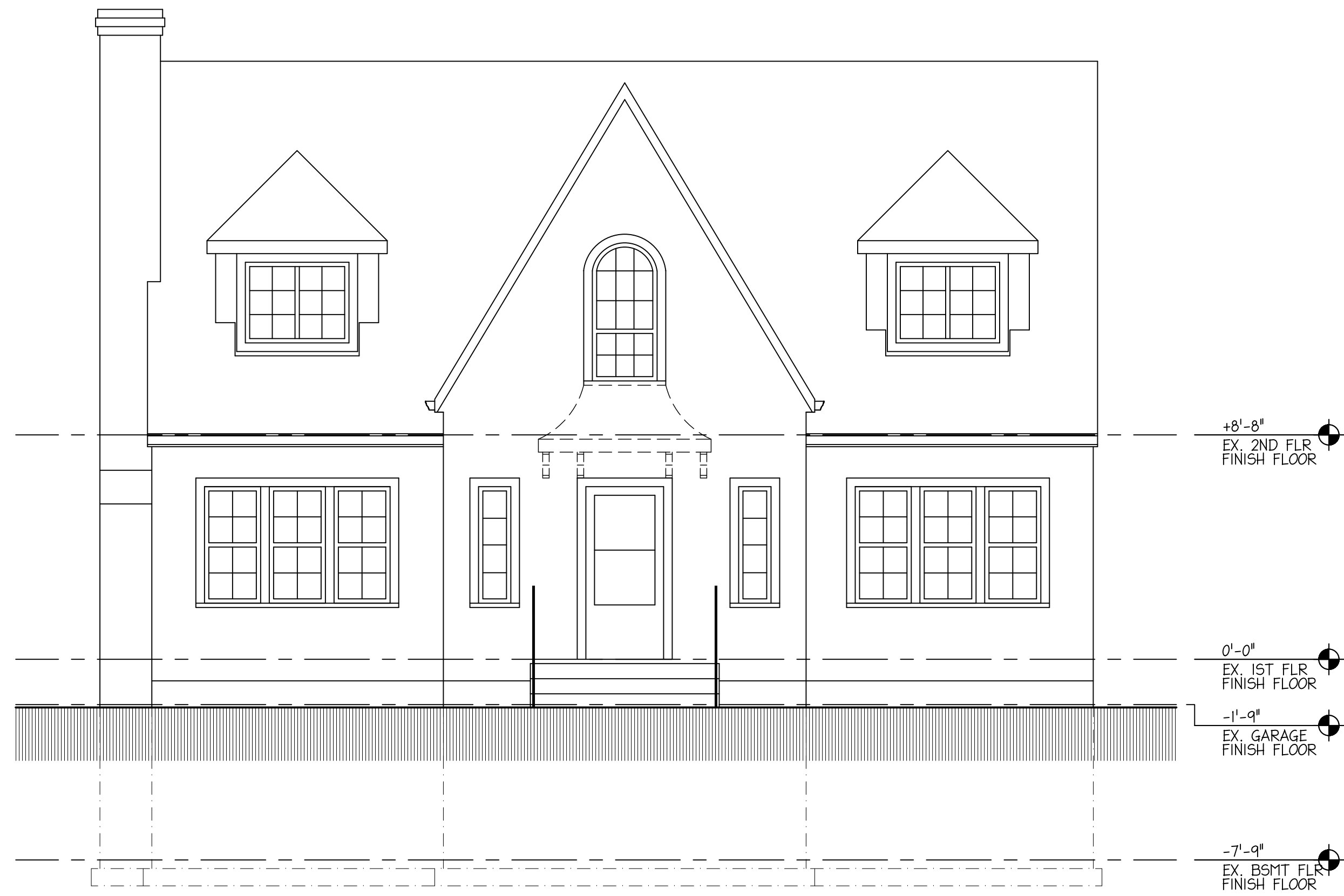
A EXISTING EXTERIOR 'FRONT' ELEVATION A103 SCALE: 1/4"=1'-0"
