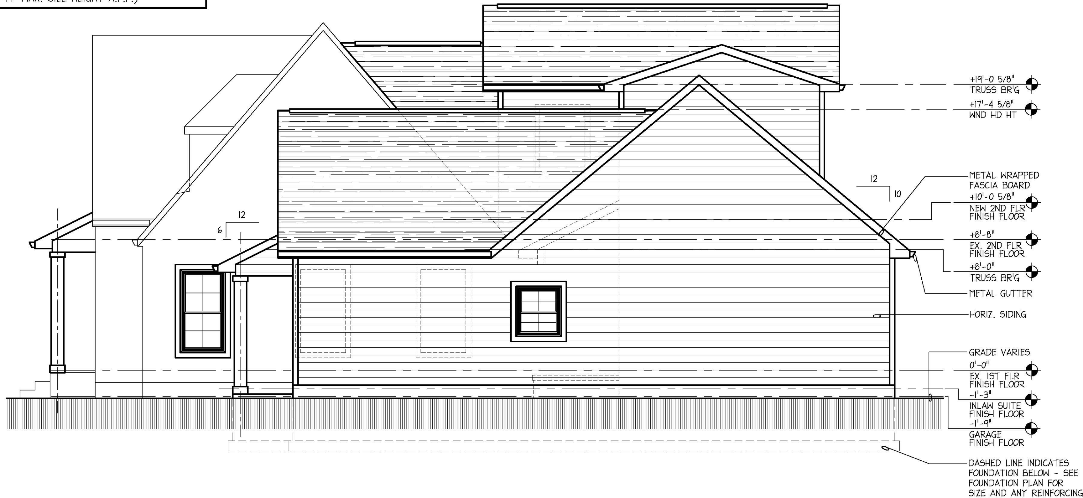
B EXTERIOR 'SIDE' ELEVATION SCALE: 1/4"=1'-0"
